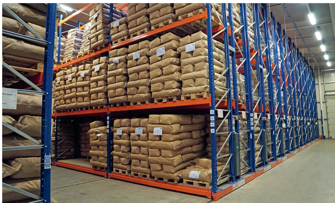
Das Gebäude, das Verwaltung, Verarbeitung und Lagerung der Ware umfasst, ist bestens isoliert. Selbst bei Sommerhitze ist keine Kühlung erforderlich. Die Regale sind verschiebbar angeordnet. Zum Be- und Entladen werden sie nach der Seite hin bewegt. Dadurch wurde die Lagerkapazität um 40 Prozent erhöht.
